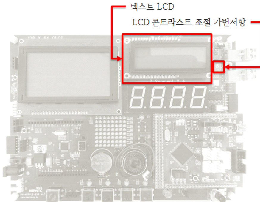
그림 3. 학습보드의 텍스트 LCD와 콘트라스트 조절용 가변저항
