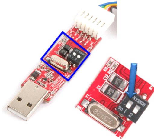
그림 6. USB 전원 공급을 위한 ISP 장치의 DIP 스위치
