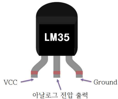
그림 1. LM35 온도 센서
