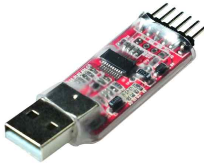
그림 7. FTDI 칩을 사용한 USB-UART 논리 레벨 변환 모듈
