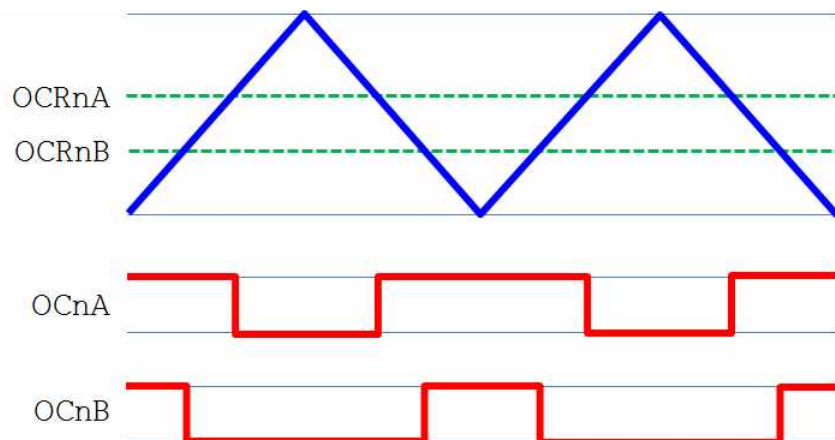
그림 11. 위상 교정 PWM 모드에서 비교일치 값에 따른 파형
