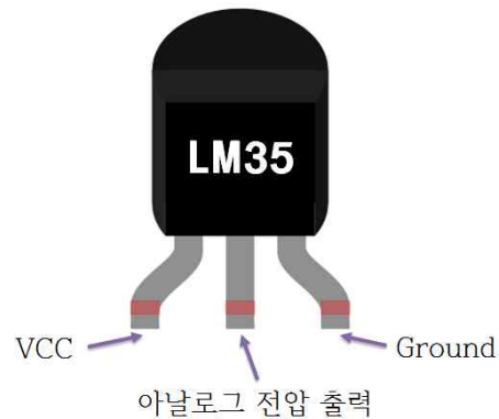
그림 7. LM35 온도 센서
