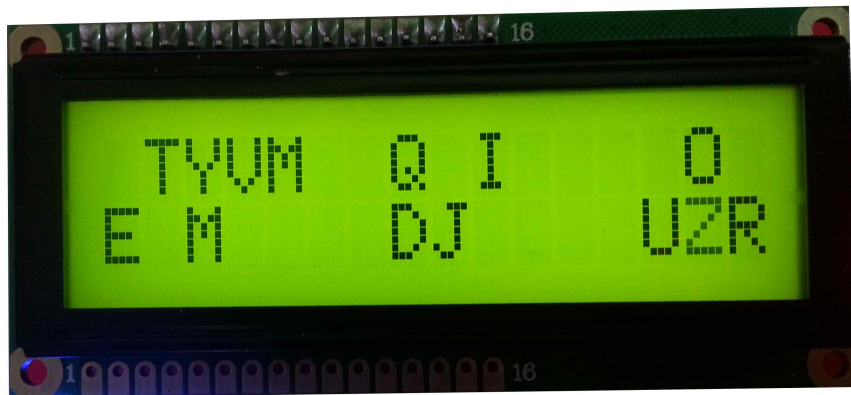
그림 4. 스케치 2 실행 결과 - 텍스트 LCD 창
