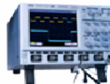
WaveRunner 6000A 350MHz~2GHz 10GS/s 2, 4채널
