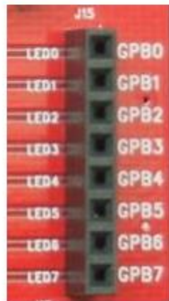
LED 의 데이터 핀을 SPI 통신으로 확장하는 커넥터 (J15)
