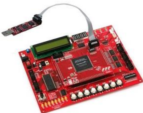
USB Blaster를 FPGA 모듈에 연결 한 사진
